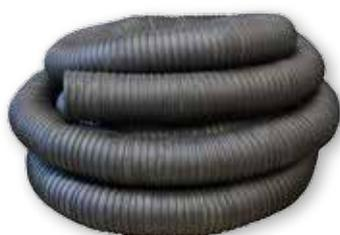
GT2 - Tuyau en caoutchouc et d'une spirale en nylon, le tuyau flexible GT2 est résistant jusqu'à 200° et est anti-écrasement. Il est disponible en diamètre 75, 100, 125, 150 et 200 mm pour des longueurs de 2,5 à 40 m.
